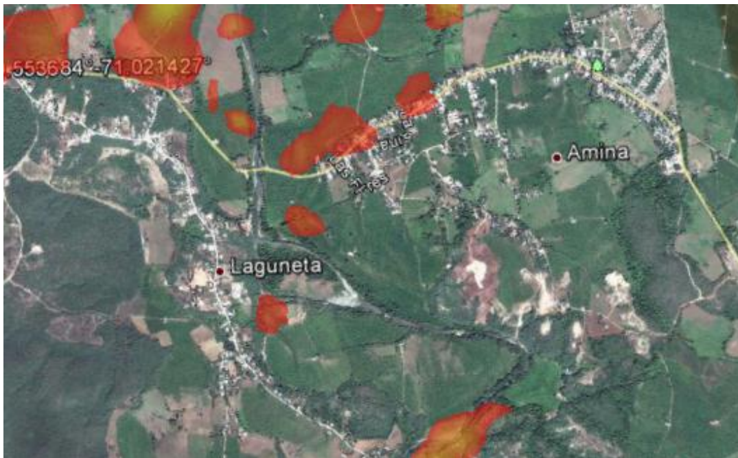
Figura 13. Inundaciones en la ciudad de Amina durante una tormenta de 100-años por 24-horas con la presa propuesta y a al 75% de la capacidad del embalse
